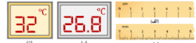
شکل ۱-۵ خطای اندازه‌گیری (الف) با خط‌کش سانتی‌متری برابر 0.5 \text{ cm} ، (ب) با خط‌کش میلی‌متری برابر 0.5 \text{ mm} ، (پ) و (ت) با دماسنج‌های رقمی به ترتیب برابر 1^\circ \text{C} و 0.8^\circ \text{C} است.
