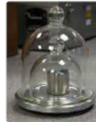
شکل ۱-۱ استاندارد ملی کیلوگرم که نسخه دقیقی از استاندارد بین‌المللی بیور فرانسه است. این نمونه در مرکز اندازه‌مندی سازمان ملی استاندارد ایران نگهداری می‌شود.
