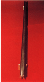
میله ای از آلایژ پلاتین ایریدیوم به نام متر استاندارد
